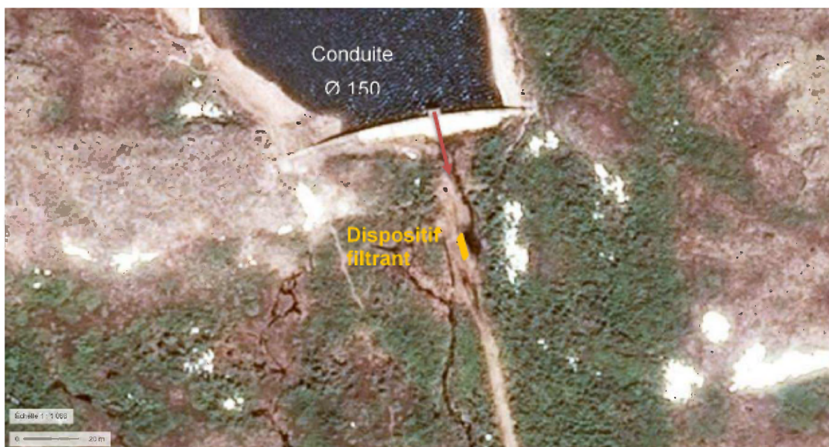
Figure 8 : Schéma de principe du dispositif d'abaissement de la retenue envisagé
