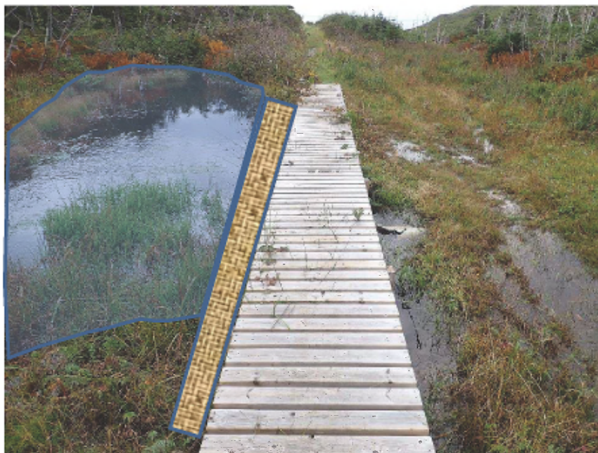
Figure 10 : Schéma de principe de mise en place d'une barrière filtrante préventive en aval (Zone bleue = aire d'évolution des poissons et de pêche électrique de sauvetage)
