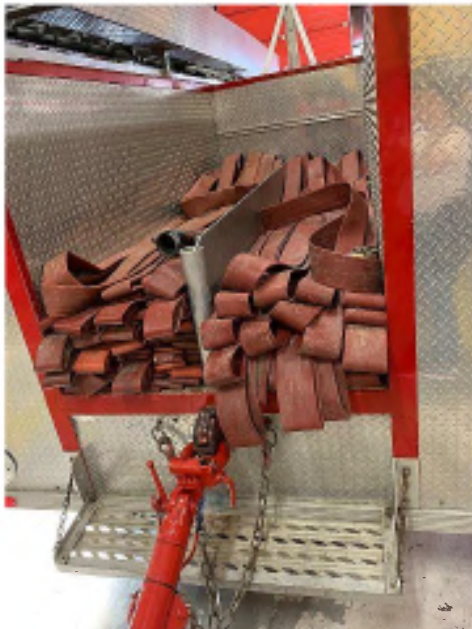
Tuyaux plats d70mm ; crépine et flotteur – matériel des sapeurs-pompiers de la ville de St Pierre
