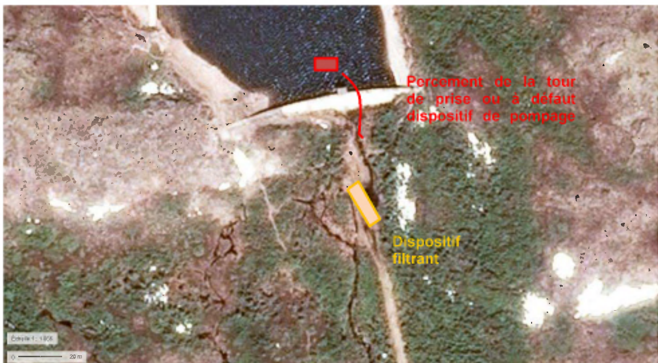
Figure 11 : Schéma de principe du dispositif de vidange final
